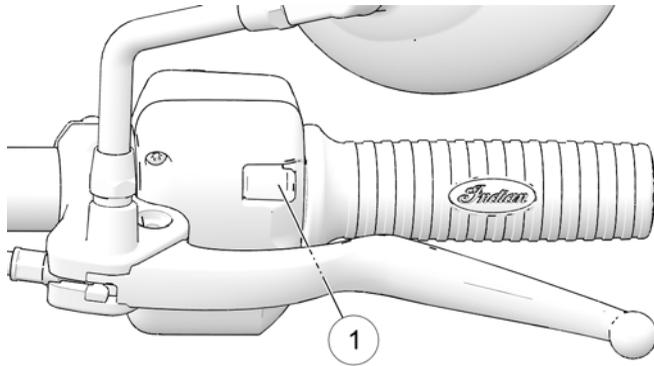
O interruptor de ligar/desligar tem de estar ligado para que os interruptores basculantes funcionem. Utilizar o interruptor do lado direito para navegar através dos menus ou aceitar caixas de diálogo no display Ride Command. Utilizar o interruptor do lado esquerdo para retroceder nos menus, cancelar caixas de diálogo, desligar chamadas telefônicas e alternar entre os ecrãs no display.
