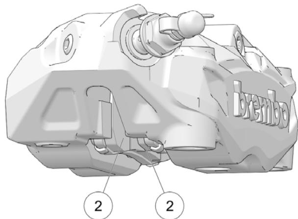
Inspecionar cada pastilha do travão dianteiro de ambos os lados dos discos dianteiros. Inspecionar cada pastilha do travão traseiro de ambos os lados do disco traseiro. Substituir as pastilhas dos travões quando o ponto mais fino do material de fricção ② se tiver desgastado até 1,0 mm. Consultar o concessionário para esta revisão.
