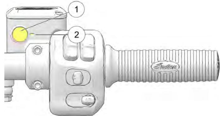
3. O nível do líquido deve estar acima da marca indicadora de mínimo ② no indicador de nível transparente.
