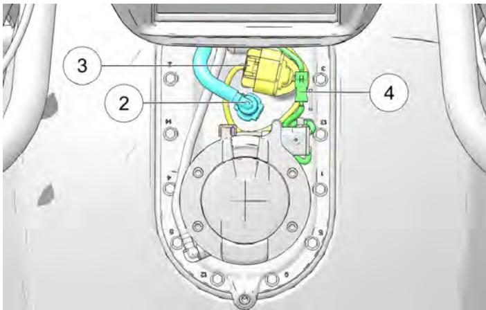
5. Desligar o conector elétrico da bomba de combustível ③.
