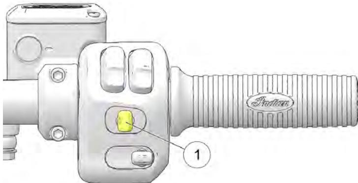
O controle da velocidade de cruzeiro pode ser ativado e ajustado a partir do comando direito, usando o interruptor de controle da velocidade de cruzeiro ①.
