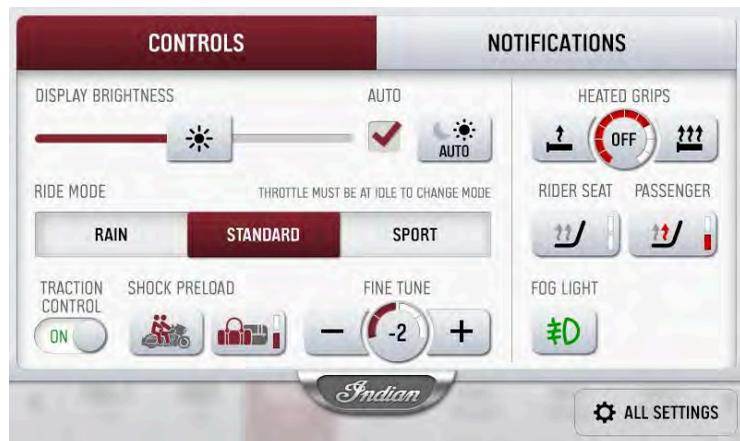
No painel de comando pode aceder-se às definições, ajustar o brilho do display, seleccionar o modo de condução e os comandos de climatização do veículo.
