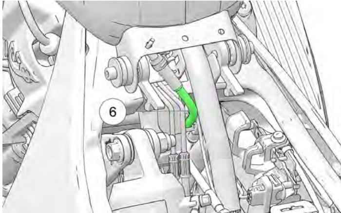
11. Nos modelos equipados com um sistema EVAP, remover a linha de ventilação EVAP localizada por cima do cartucho filtrante EVAP no lado direito do depósito de combustível ⑦.
