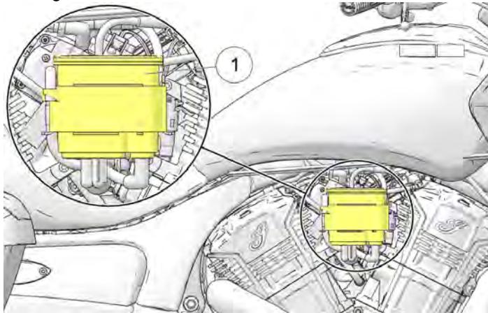
3. Inspeccionar as ligações no cartucho filtrante das emissões por evaporação para garantir que estão firmemente fixas. A linha
