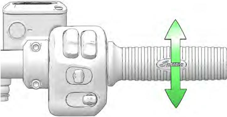
3. Rodar o dispositivo de ajuste do cabo para dentro ou para fora até que a folga da manete da embraiagem seja de 0,5 a 1,5 mm, tal como medido no suporte da embraiagem.
