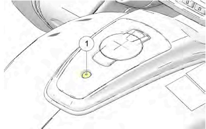
2. Com o elemento de aperto/fixação removido, levantar a parte de trás da consola o suficiente para limpar o tampão do depósito de combustível e empurrar para a frente para libertar o suporte frontal da chaveta.
