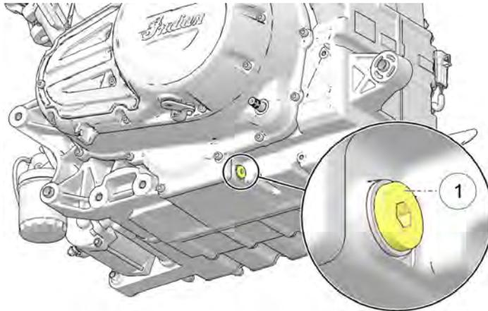
4. Remover o bujão de drenagem. Permitir que o óleo drene completamente.
