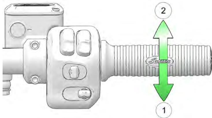
O punho de controlo tem um acionamento por mola. Quando se solta o punho, o acelerador regressa à posição de ralenti.
