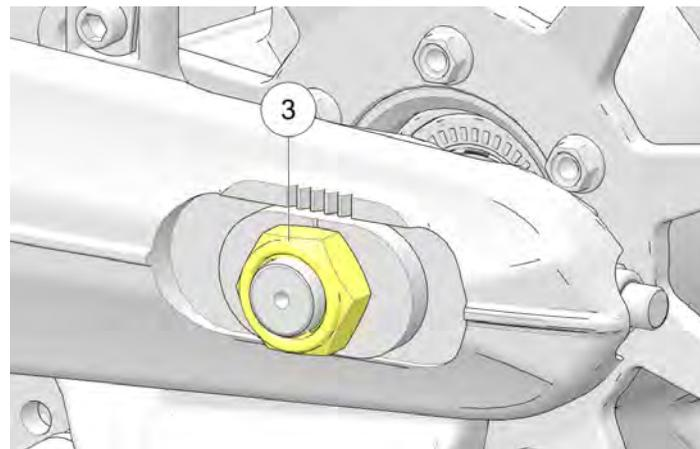
6. Rodar a porca de ajuste do LADO DIREITO ④ para tensionar a correia corretamente.
