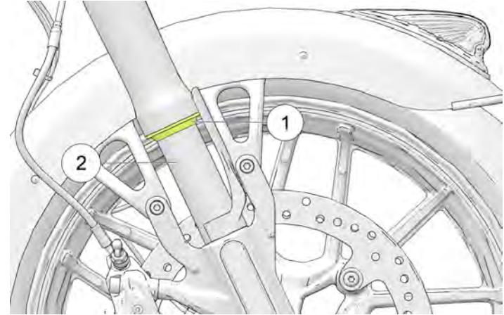
2. Limpar os tubos da forquilha para remover insetos, alcatrão ou depósitos de detritos que possam causar desgaste dos vedantes ou fugas. Inspeccionar as superfícies exteriores dos tubos interiores da forquilha em relação a riscos ou danos causados por objetos estranhos.
