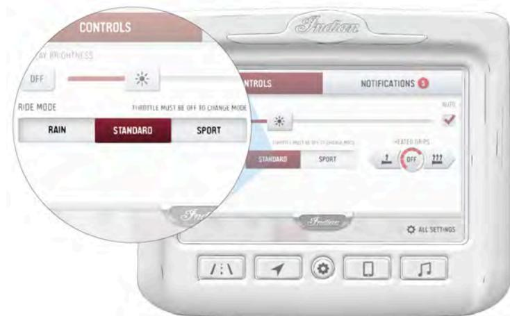
Existem três modos de condução, Rain, Standard e Sport (chuva, padrão e desportivo), que permitem uma experiência personalizada de acordo com o estilo de condução pessoal. O mapeamento do motor para cada modo de condução foi concebido tendo em mente uma aplicação específica, resultando num motociclo com três personalidades distintas.
