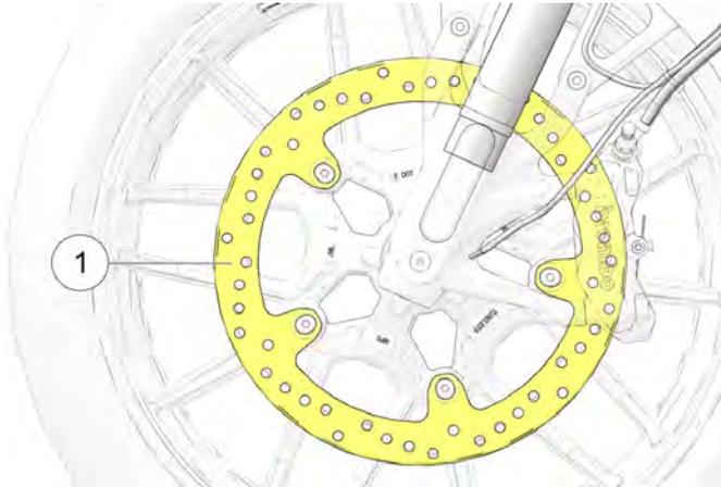
2. Limpar os discos se começar a ocorrer uma leve chiadeira devido a sujidade ou pó. Aplicar um produto de limpeza de travões num pano de oficina e limpar os discos. **NÃO** permitir que o produto de limpeza de travões entre em contacto com peças pintadas ou de plástico. Ler todas as precauções no rótulo.
