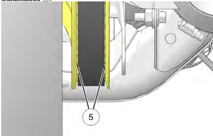
3. Se necessário, desapertar a porca do eixo e a porca de ajuste do LADO ESQUERDO até que a correia se desloque do flange direito e comece a seguir o centro do flange da roda dentada conduzida durante a rotação da roda em frente.
