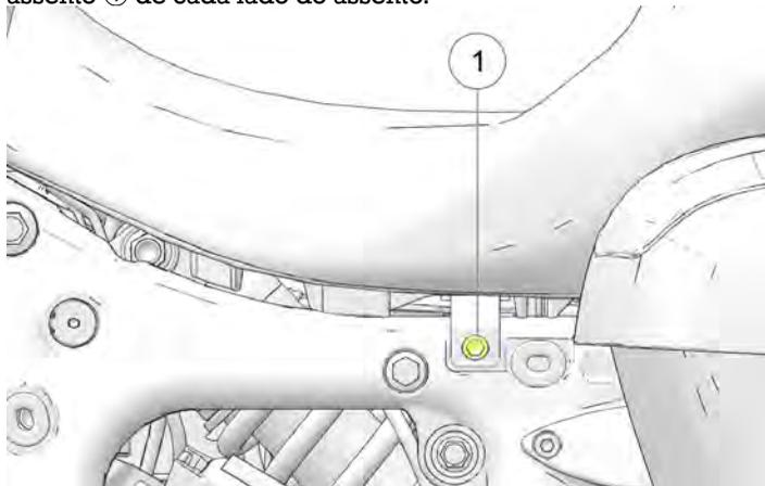
3. Puxar o assento para trás para desengatar as linguetas de montagem no assento do suporte do quadro. Não permitir que as ferragens do suporte do assento entrem em contacto com o guarda-lamas traseiro.
