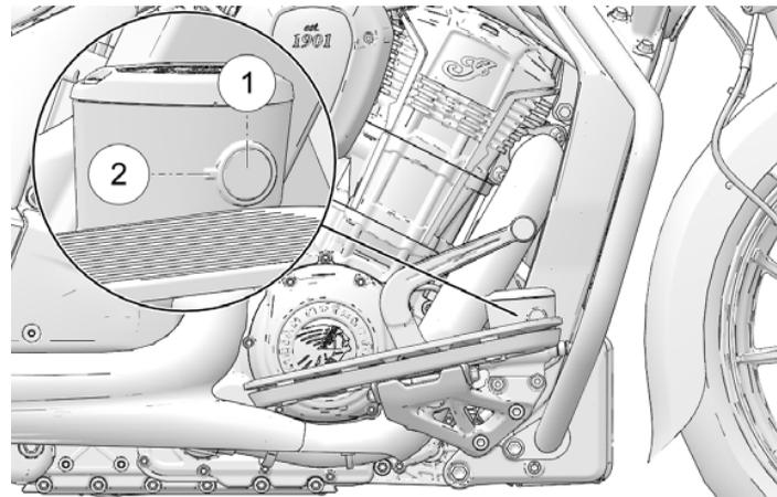
6. Reinstalar a tampa e a placa da membrana.
