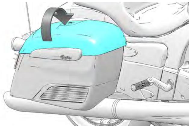
2. Pressionar firmemente a tampa até que o trinco esteja completamente engatado e a tampa esteja bem fechada.
