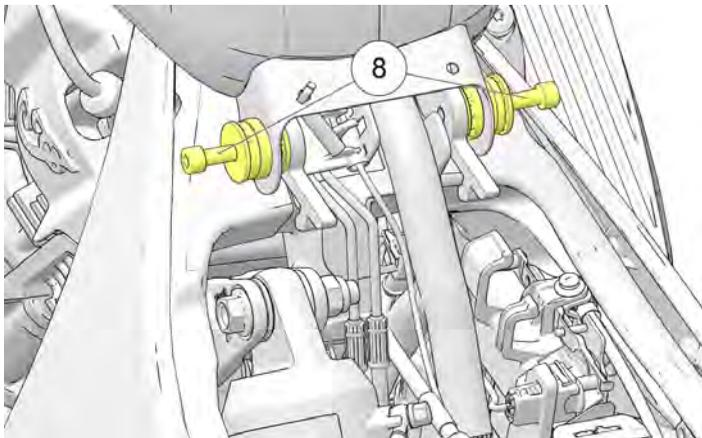
13. Levantar a parte traseira do depósito para cima e puxar para trás para remover. Colocar o depósito de combustível num local seguro com uma bandeja de drenagem para apanhar o combustível que possa vazar ou pingar de mangueiras ou acessórios separados.
