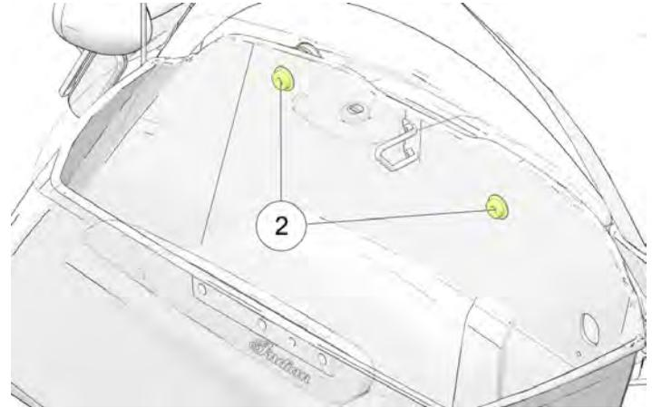
6. Incliná-lo na direção oposta à do quadro do veículo para o remover.
