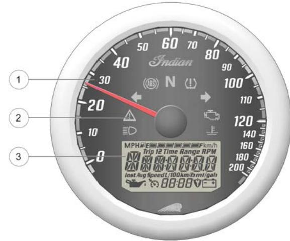
O painel de instrumentos inclui o velocímetro, as luzes de aviso e o display multifunções (MFD).
