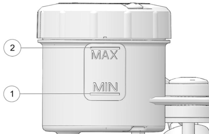
2. Observar o nível do líquido do travão dianteiro através do depósito do líquido do travão. O líquido deve ser claro e estar entre as marcas MIN ① e MAX ②.
