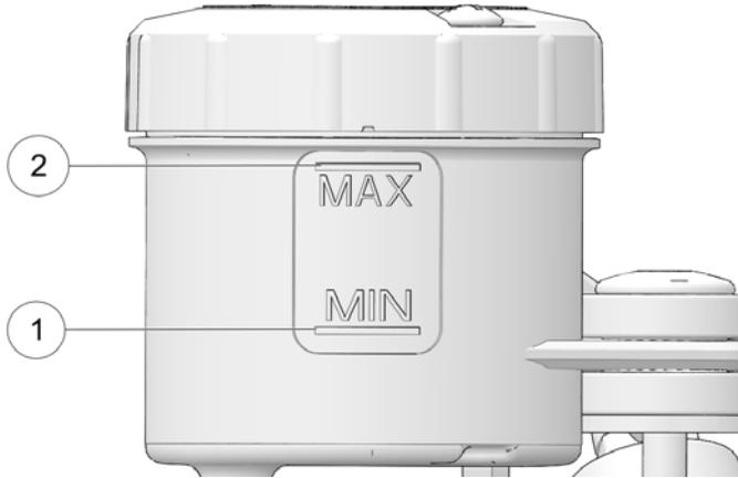
2. Observar o nível do líquido do travão dianteiro através do depósito do líquido do travão. O líquido deve ser claro e estar entre as marcas MIN ① e MAX ②. Se o nível do líquido estiver baixo, inspecionar as pastilhas do travão, conforme descrito na página 142. Se as pastilhas não estiverem gastas para além do limite de serviço, inspecionar o sistema dos travões em relação à presença de fugas.
